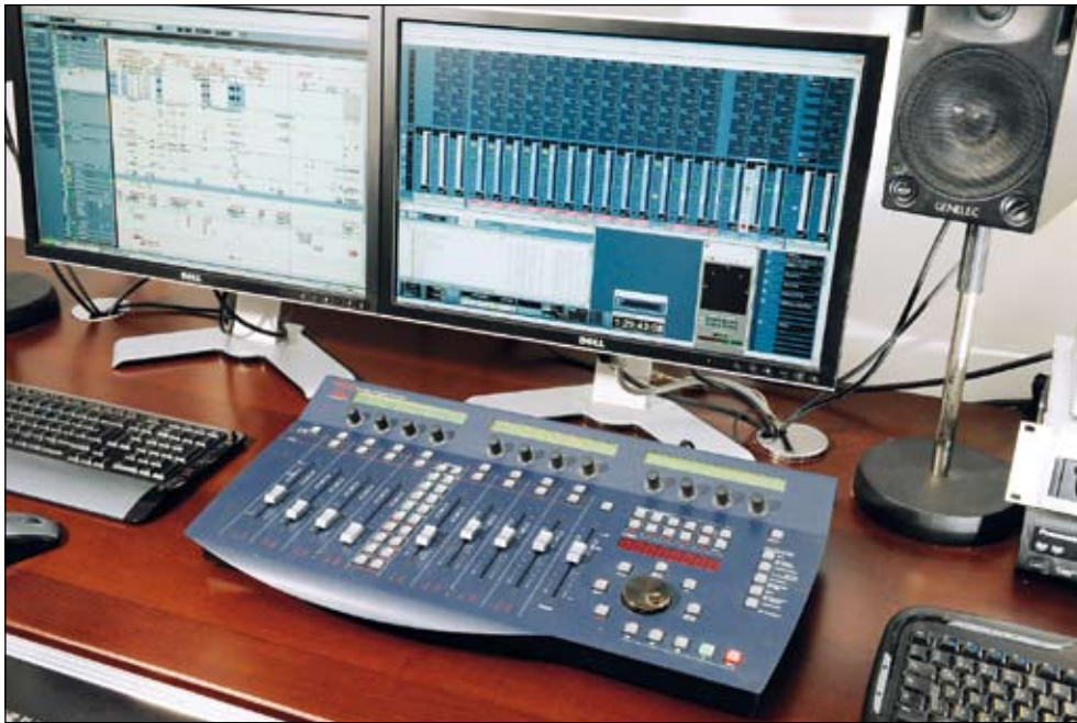
Platzsparende digitale Controllerlösung statt ausladender analoger Mischpulttechnik
