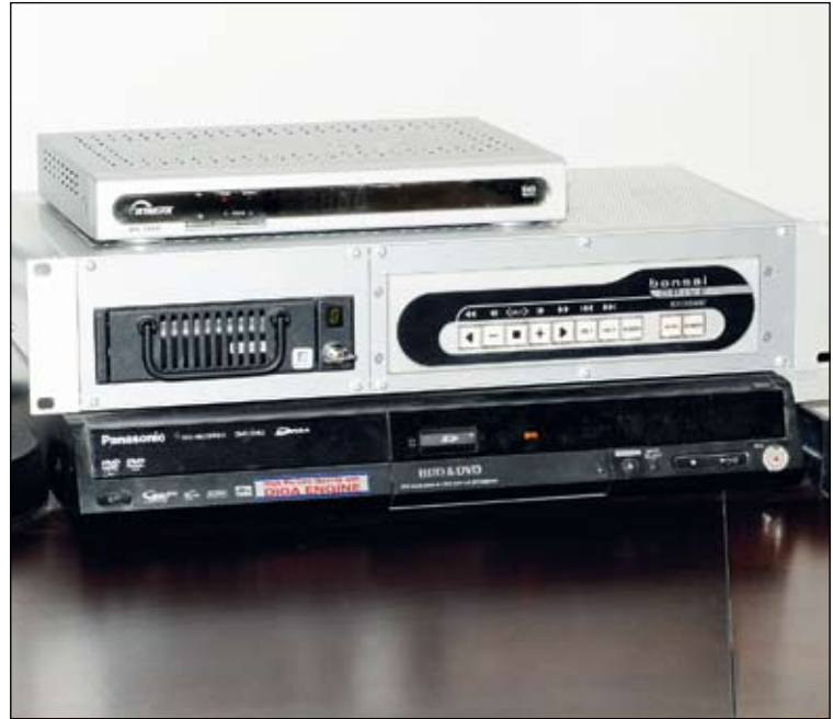
Als externer Bildzuspieler entlastet der Rosendahl bonsaidrive den Computer
